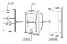
3、卡上装饰盖,安装完成(安装前,请先进行联网设置)。
